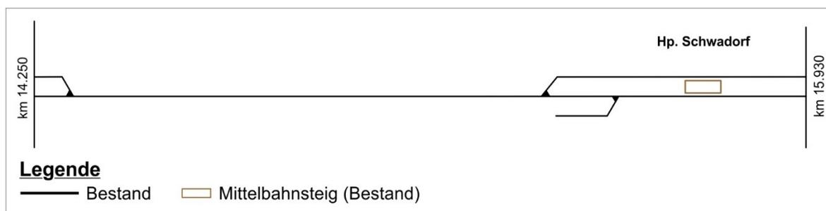
Abbildung 4 Streckenband des Abschnitts Badorf – Schwadorf im Bestand
