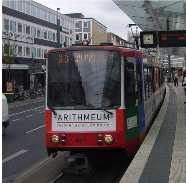
Foto 1: fehlerhafte Anzeige der Fahrgastinformation außen
