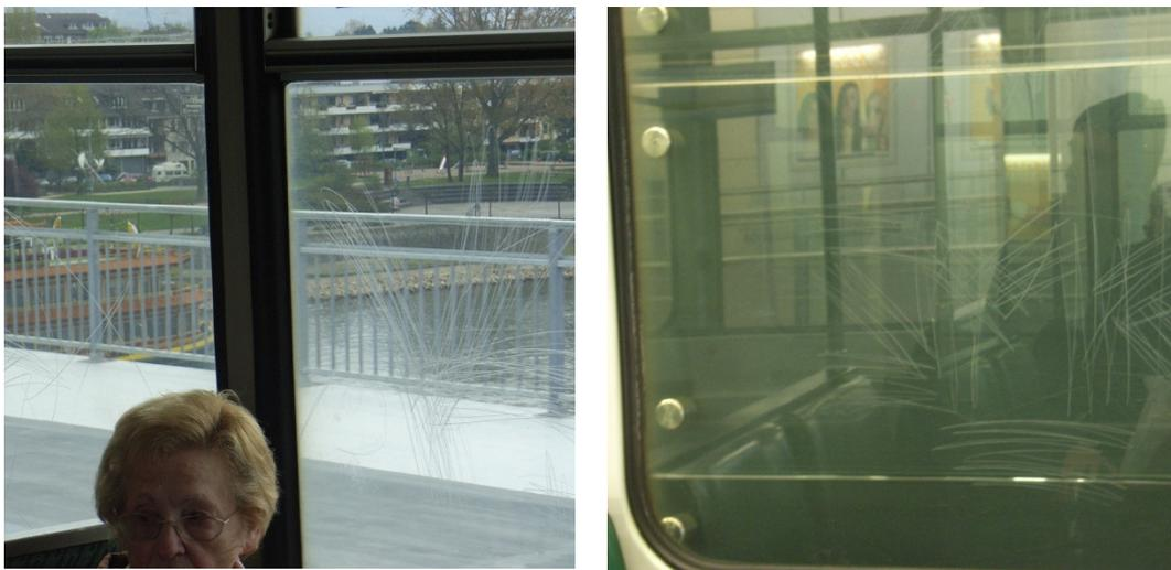
Foto 9: großflächige zerkratzte Scheiben mit Sichtbehinderung
